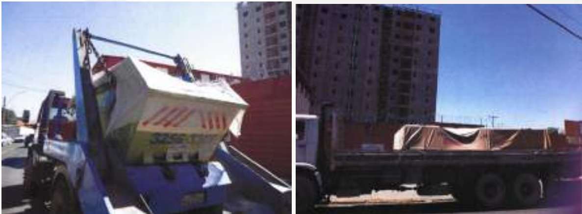
Figura 17. Exemplos de “lonamento” em caçamba de entulho e caminhão, para prevenção de poluição difusa.
